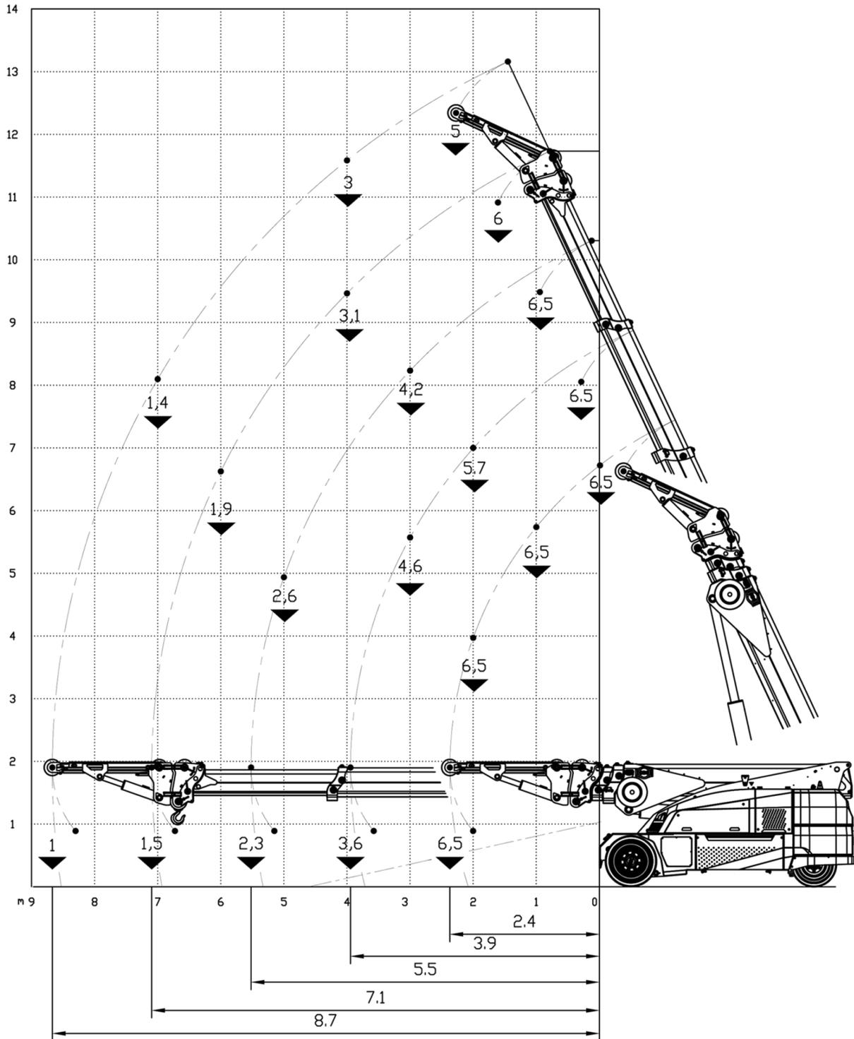
**Flèche de base avec Jib hydraulique 6,5t, inclinable de +8° à -60° avec barre stabilisatrice**
