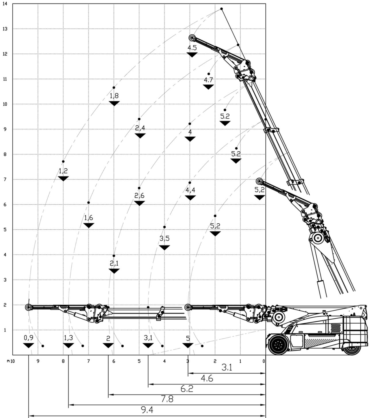
**Flèche de base avec Jib hydraulique 6,5t extensible et inclinable de +8° à -60° avec barre stabilisatrice**
