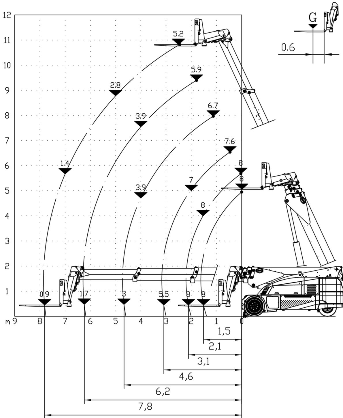
**Flèche de base avec Jib hydraulique 6,5t, inclinable de +8° à -60°**
