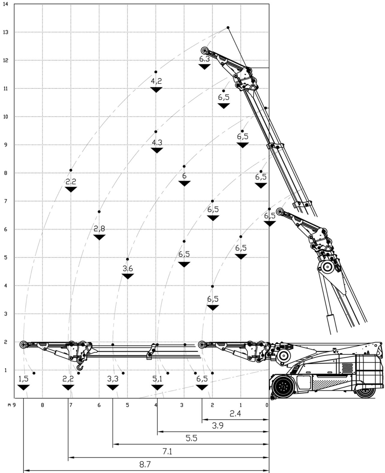
**Flèche de base avec Jib hydraulique 6,5t extensible et inclinable de +8° à -60°**
