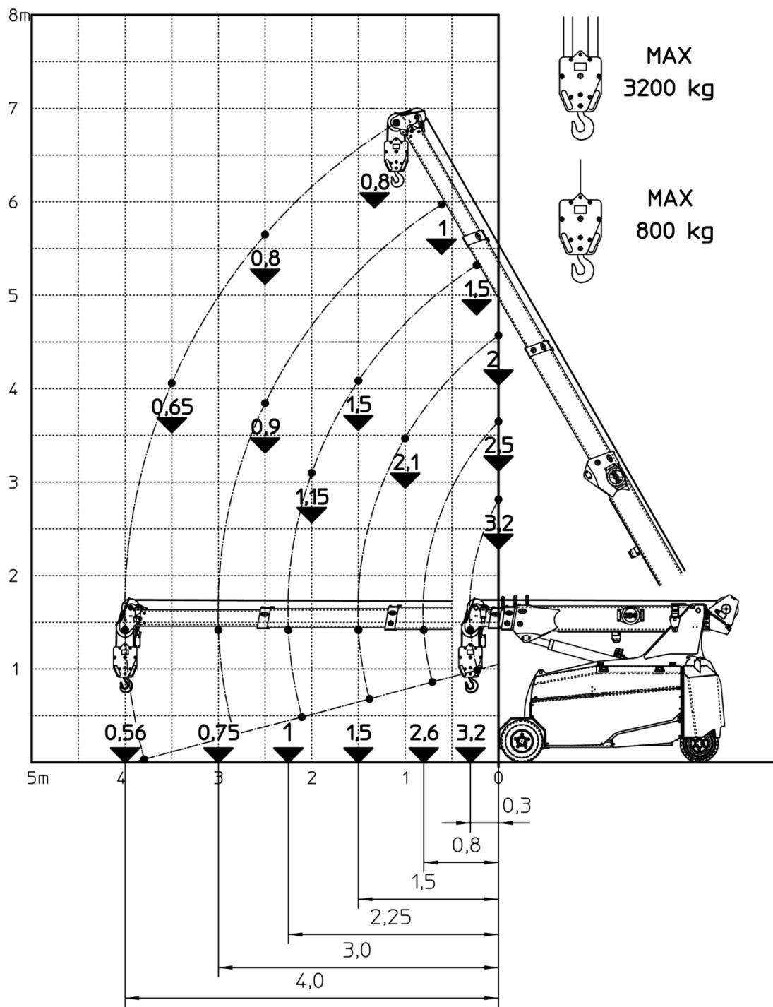
**Fleche de base + Jib mecanique 1,5t, inclinable 3 positions 0-25-50°**
