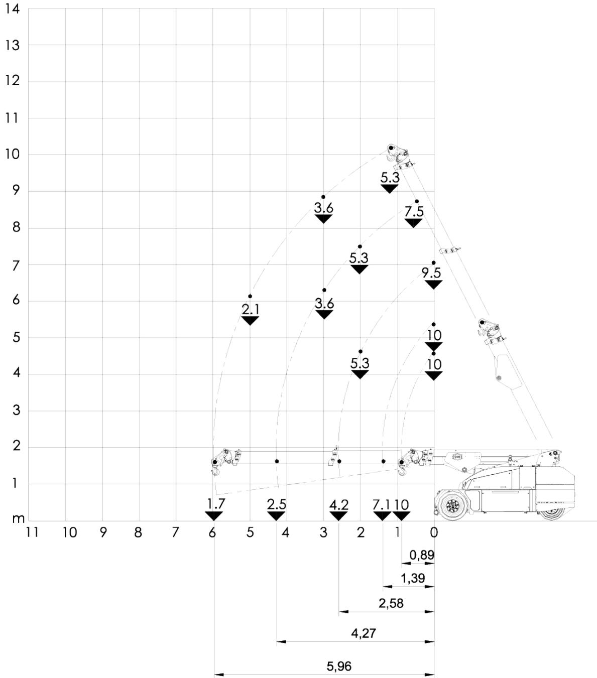
**Flèche de base avec crochet 45° avec barre stabilisatrice**
