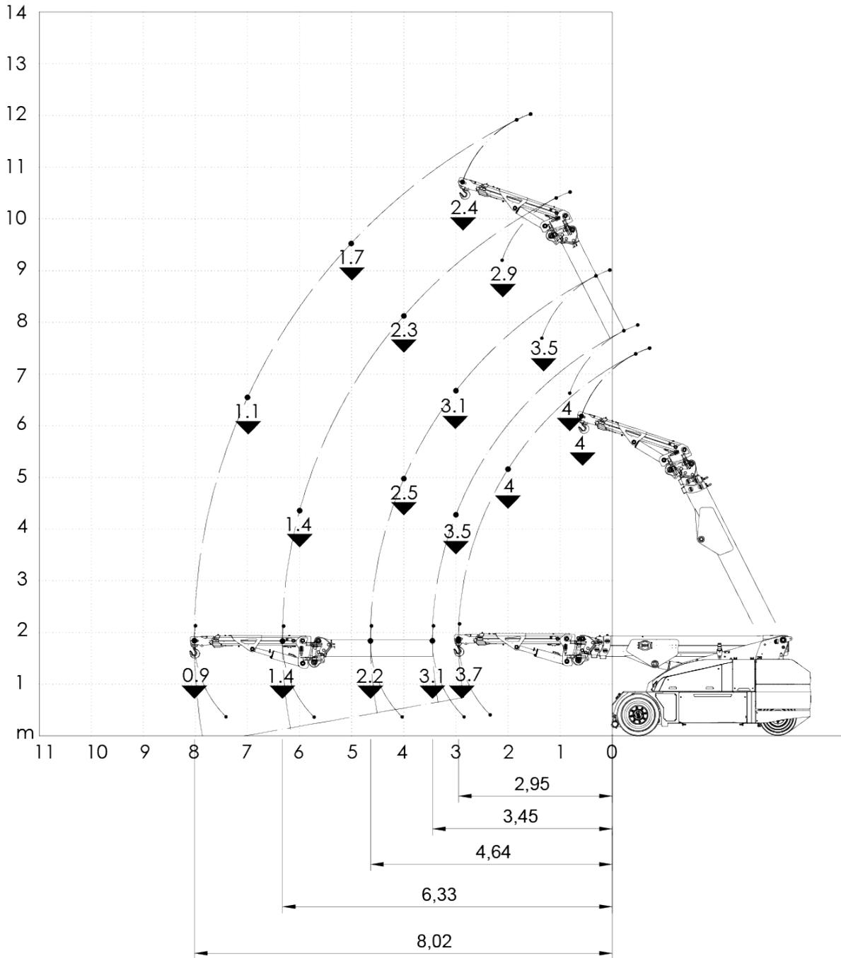
**Flèche de base avec Jib hydraulique, inclinable de +8° à -60° avec barre stabilisatrice**
