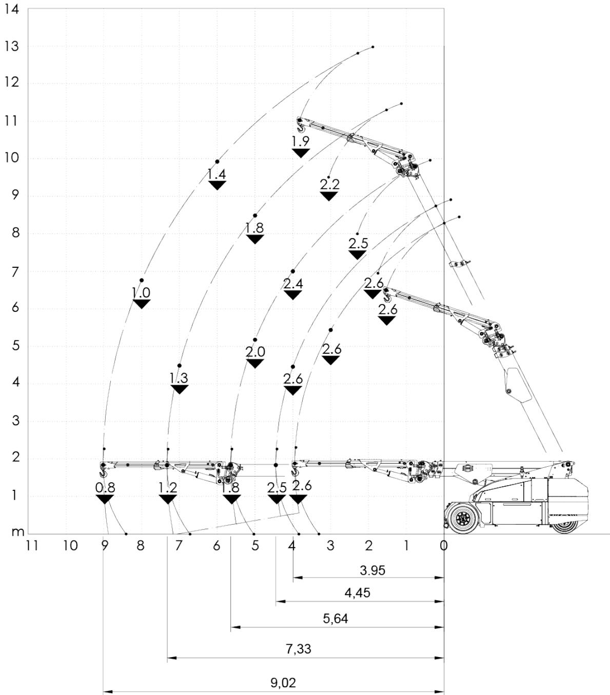
**Flèche de base avec Jib hydraulique extensible, inclinable de +8° à -60° avec barre stabilisatrice**
