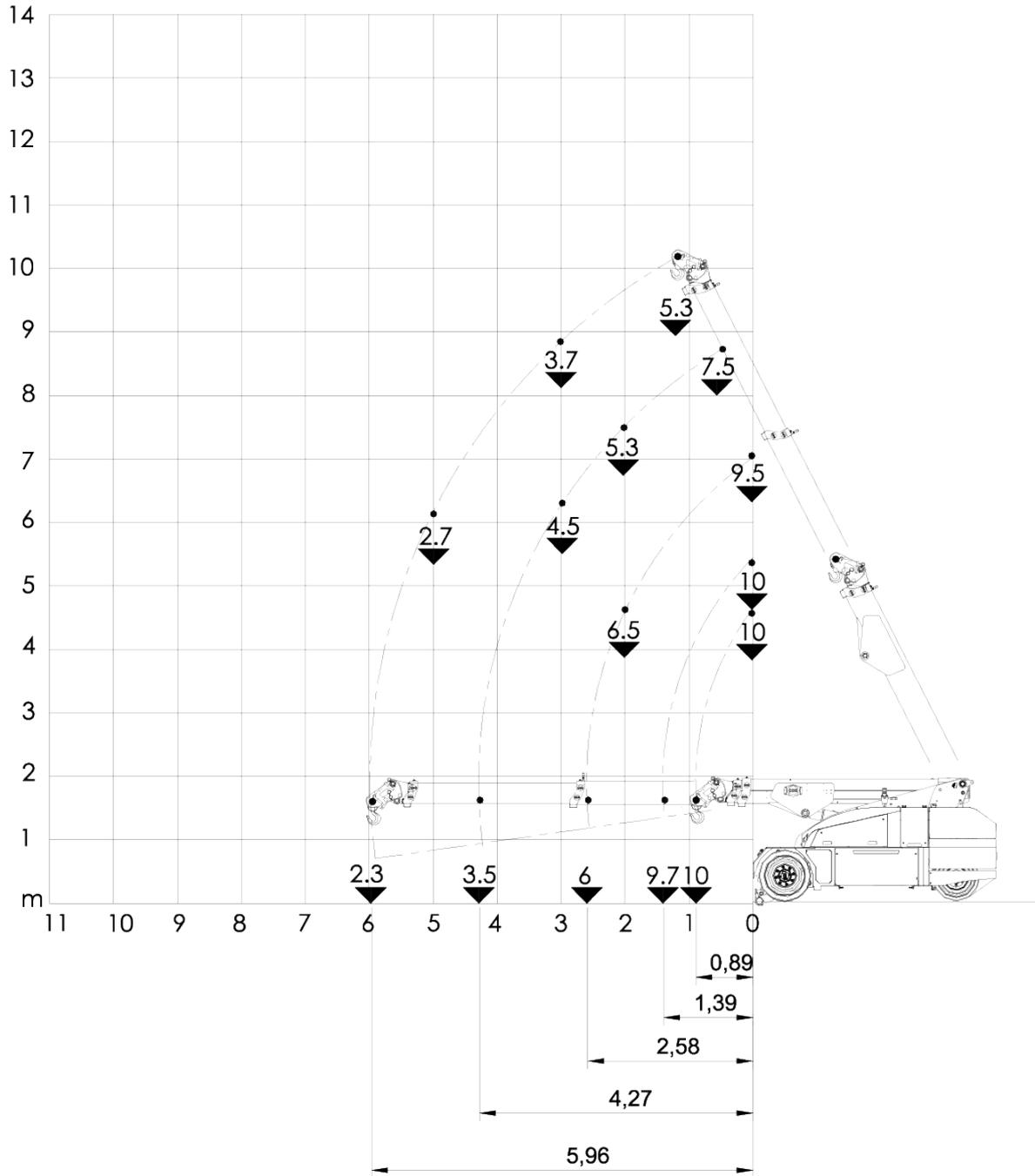
**Flèche de base avec Jib hydraulique, inclinable de +8° à -60°**
