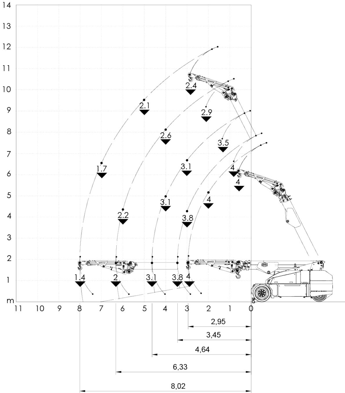
**Flèche de base avec Jib hydraulique extensible, inclinable de +8° à -60°**
