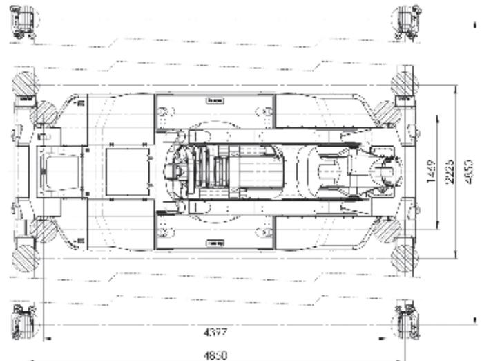
Grue «CARRY-DECK» à tourelle tournante. Rotation de flèche hydraulique sur 360° continu et illimité.
